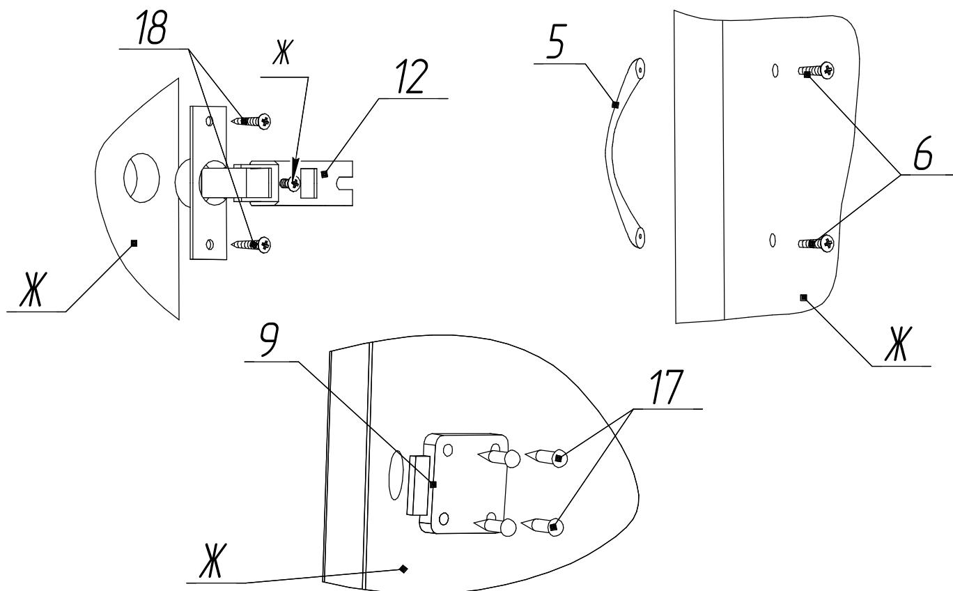
9. Навесить двери на каркас тумбы, зафиксировать их положение винтами. Отрегулировать положение двери винтами Ж по вертикали и горизонтали.
