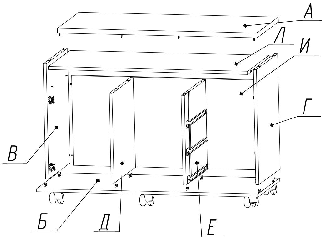
7 Сверху установить крышку тумбы поз. А. Повернуть эксцентрик по часовой стрелке, стянуть крышку и стенки боковые между собой.
