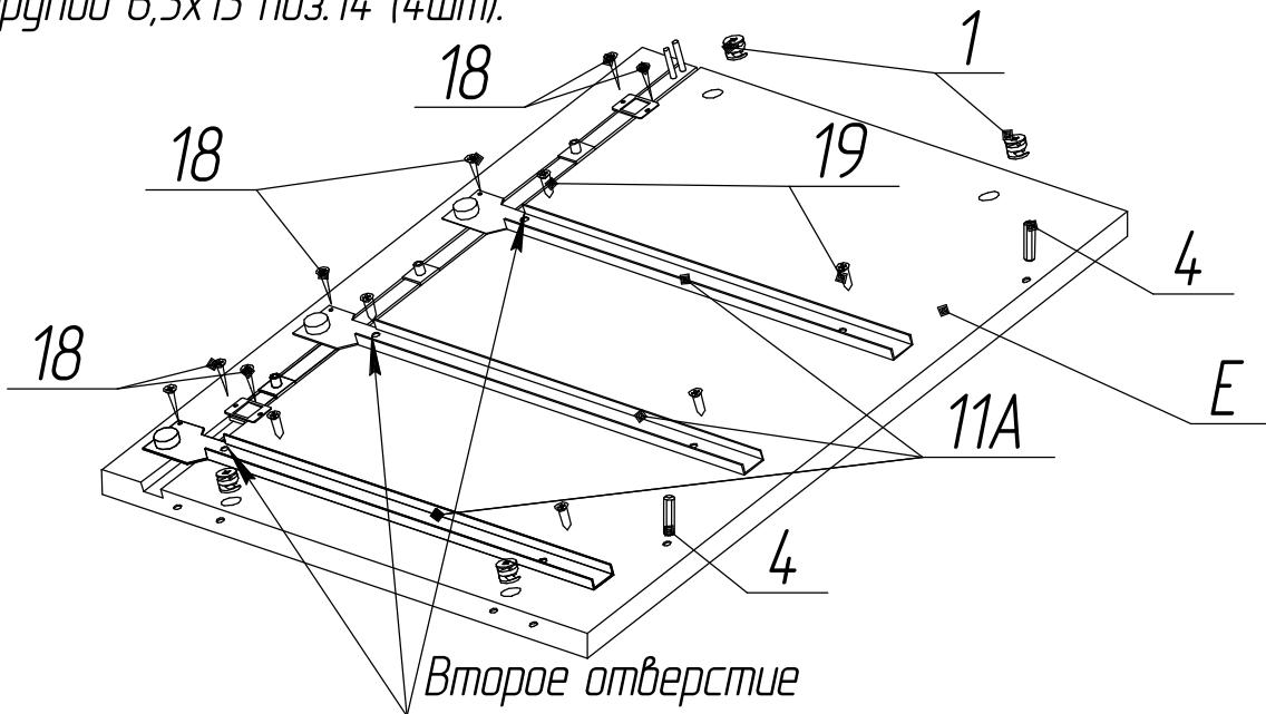
4 К перегородке поз. Е прикрутить планку центрального замка поз.7 шурупами поз.18 .К стенке боковой поз. Г и перегородке поз. Е прикрутить направляющие роликовые поз.11А.
