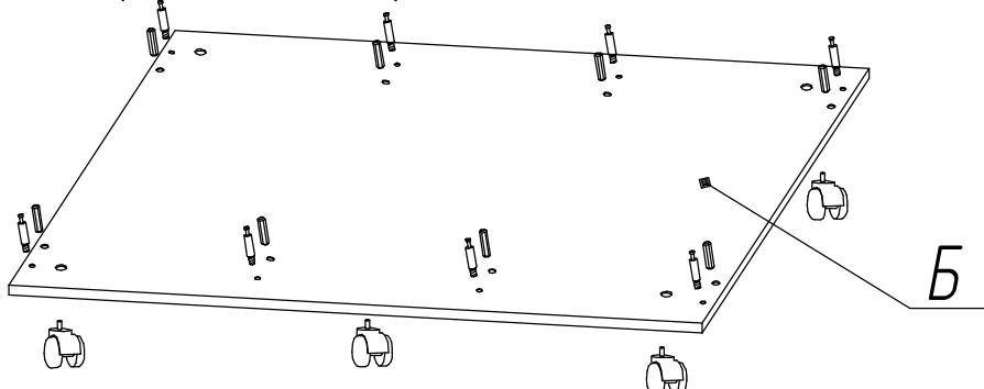
2 В стенки боковые поз. В и Г и перегородки поз. Д и Е в отверстия диаметром 15 мм вставить эксцентрики поз. 1 (16 шт). В стенки боковые поз. Г и Д в отверстия диаметром 8 мм вставить шканты поз.4 (4шт)
