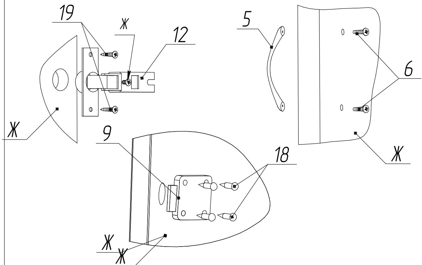
9. Навесить двери на каркас тумбы, зафиксировать их положение винтами. Отрегулировать положение двери винтами Ж по вертикали и горизонтали.
