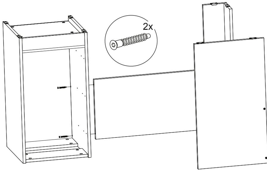
7. Установка крышки. стенки горизонтальной
