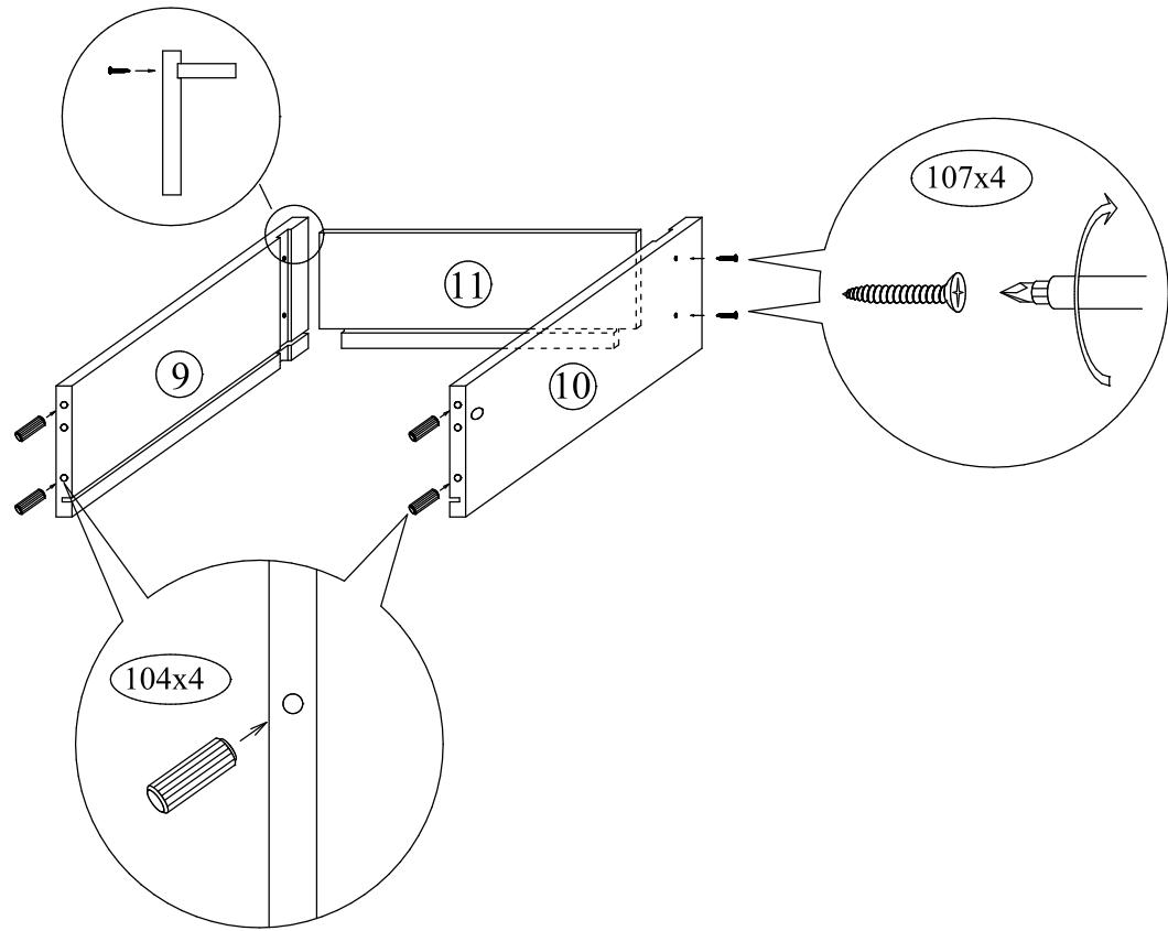
15) Установка дна в корпус ящика
