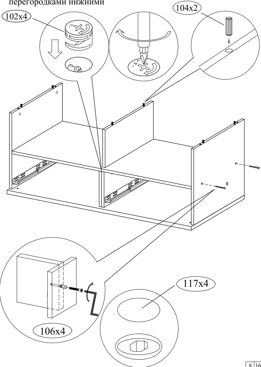
11) Соединить крышку со стенками боковыми и перегородкой верхней
