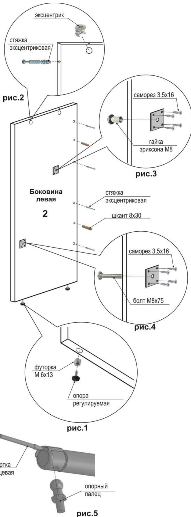
2. Установить в заднюю стенку (1) эксцентрики поз. 14 в соответствующие отверстия. Закрепить боковины с помощью эксцентриков и эксцентриковой стяжки, повернуть эксцентрики отверткой до полного прилегания боковин (2) к задней стенке (1) *эксцентрики должны находиться с наружной стороны кровати (рис.6)*. Гайку эриксона поз. 12 соединить с пальцем опорным (от газлифта), установить газлифт поз.3. **(штоком вниз)**
