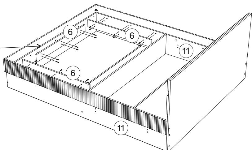
**9.** Установите подъемный механизм. Соберите ортопедической основание и установите его на подъемный механизм (более подробная инструкция по установке подъемного механизма и сборке ортопедического основания находится в упаковках ПМ и ОО).
