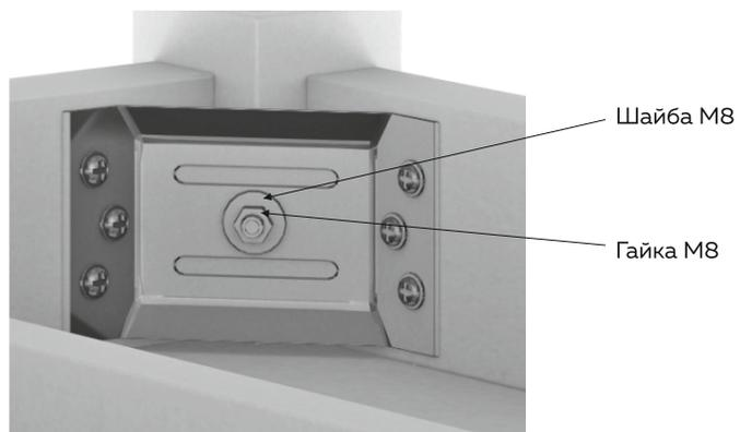
**4** С помощью шайбы М8 и Гайки М8 зафиксируйте ножку стола, используя ключ на 13
