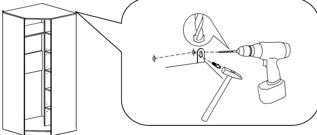
**Для избежания повреждения газовых, вентиляционных водопроводных отверстий, электрических коммуникаций, обратите внимание на их расположение!**
