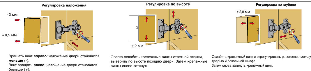
Рис. 3 Схема установки петель
