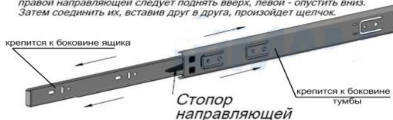
Рис.5 Схема установки шариковых направляющих
